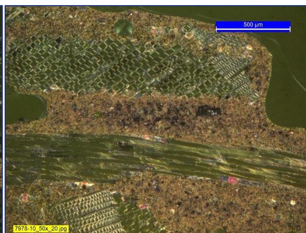
Figur 4: Typisk udseende af karbonatiseret pasta (brunlig) i prøve 10år. X-polariseret lys.
