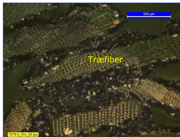
Der ses generelt ingen tegn på karbonatisering af cementpastaen inde i troldektpladen. Pastaen (CSH) fremstår sort med lyse partier, typisk CH og C 2 S.
