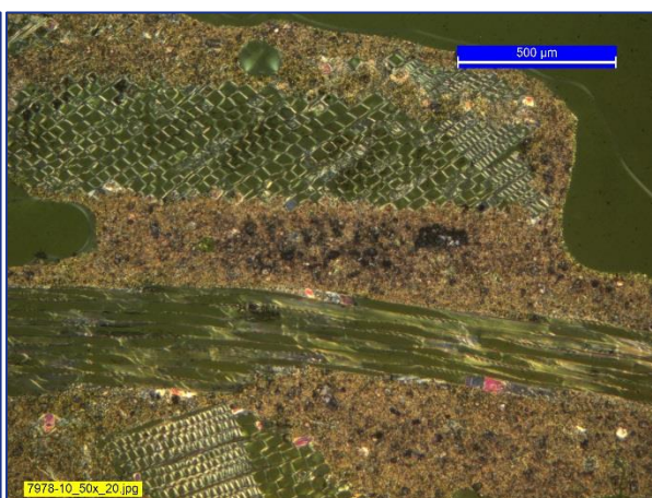
Figur 2: Typisk udseende af karbonatiseret pasta (brunlig) i prøve 10år. X-polariseret lys.
