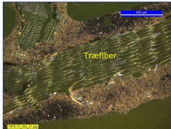
En stor del af cementpastaen fremstår karbonatiseret (brunlig), dog ses sporadisk mørke pastaområder, dels inde i prøven, dels langs prøvens kant.
