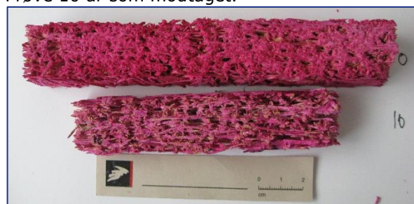
De 2 friske snit efter påsprøjtning med phenolphthalein.
